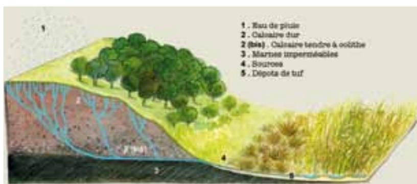
La lente descente se poursuit encore sur quelques dizaines de mètres. Puis, l'eau souterraine est arrêtée dans sa progression par un banc de roches meubles et imperméables : les marnes.
